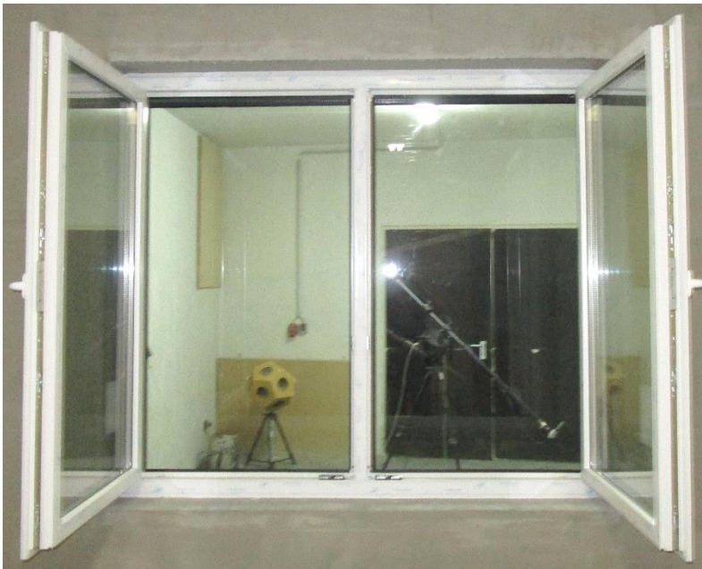
Bild A.3.1: Ansicht Prüfobjekt Schallschutzkasten mit geöffnetem Referenzfenster - Sende- raumseite
