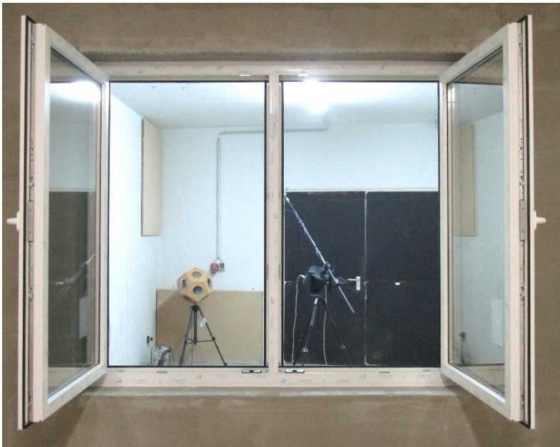
Bild A.3.1: Ansicht Prüfobjekt geöffnetes Referenzfenster - Senderraumseite
