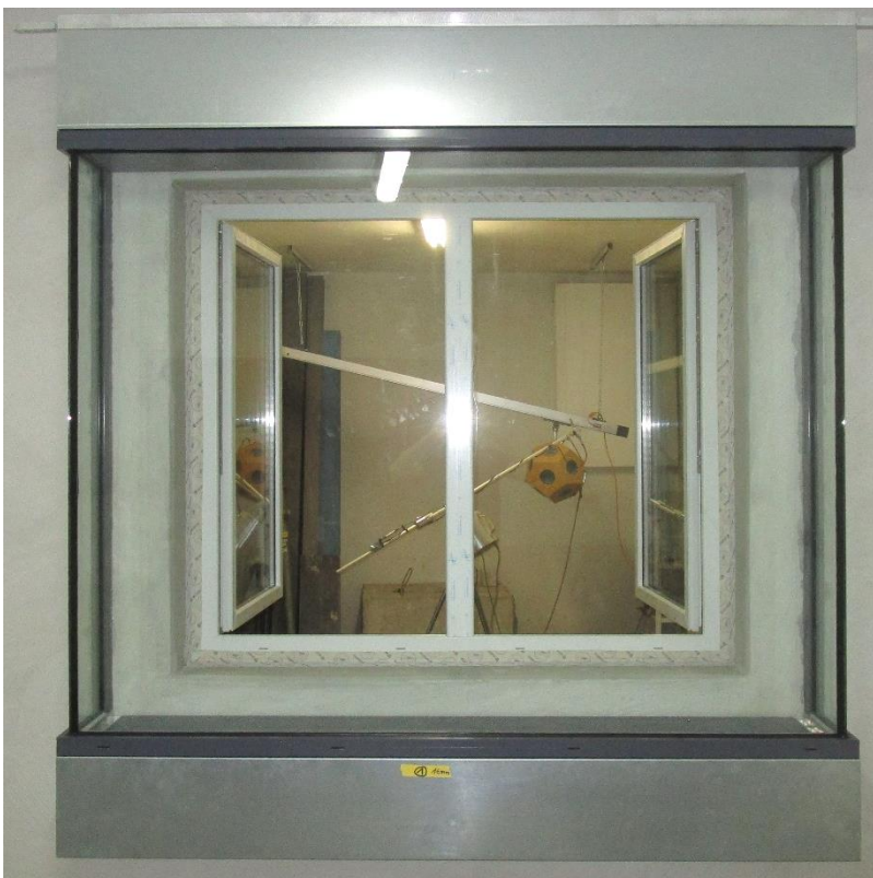
Bild A.3.2 Ansicht Prüfobjekt Schallschutzkasten mit geöffnetem Referenzfenster - Emp- fangsraumseite
