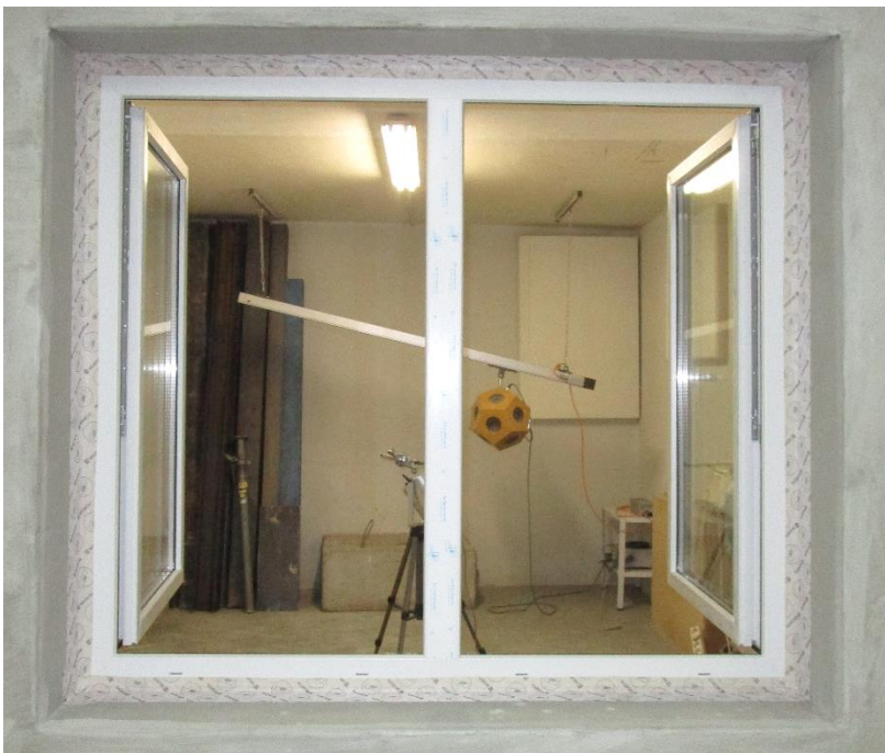
Bild A.3.2 Ansicht Prüfobjekt geöffnetes Referenzfenster - Empfangsraumseite
